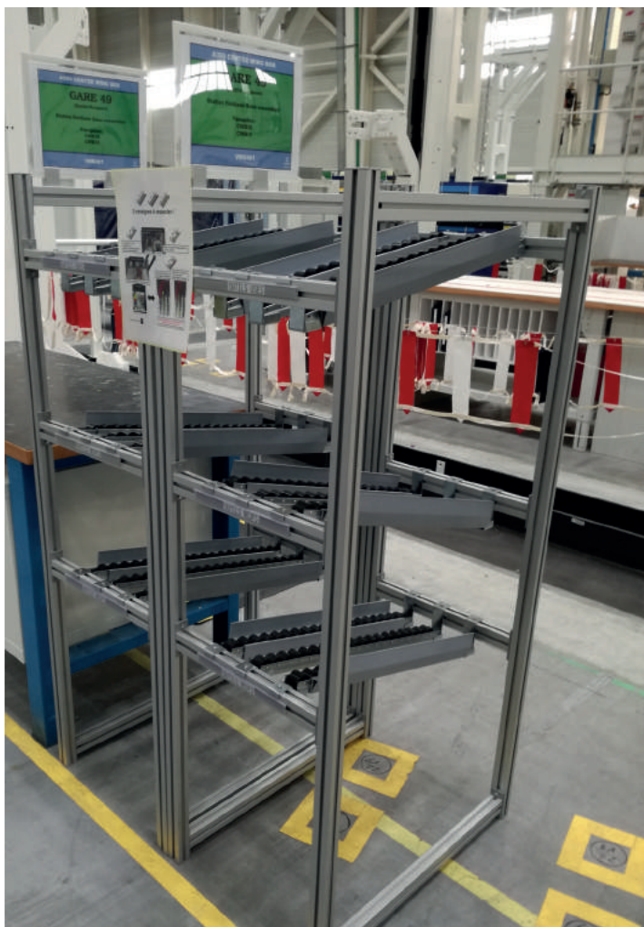
Gare approvisionnement des composants sur ligne de production Station Supply of components on production line Verteilerstation der Komponenten für die Produktionslinie
