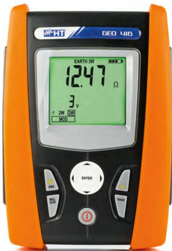
GEO416 est conçu pour **mesurer la résistance de terre à 2-fils, 3-fils et 4 fils** avec méthode **voltampèremétrique** et la résistivité du terrain extrêmement importante pendant les phases de conception des installations de terre.
